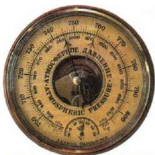
Рис. 68. Барометр-анероид
