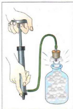
Рис. 148. Опыт, демонстрирующий уменьшение внутренней энергии системы
