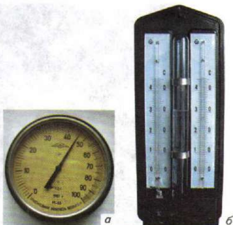
Рис. 72. Гигрометр (а) и психрометр (б)
